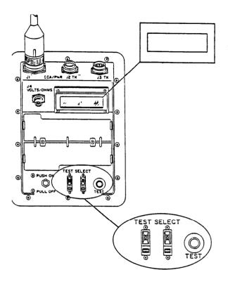
2-3-48. STARTER CIRCUIT RESISTANCE (POWER CABLE) TEST #74
